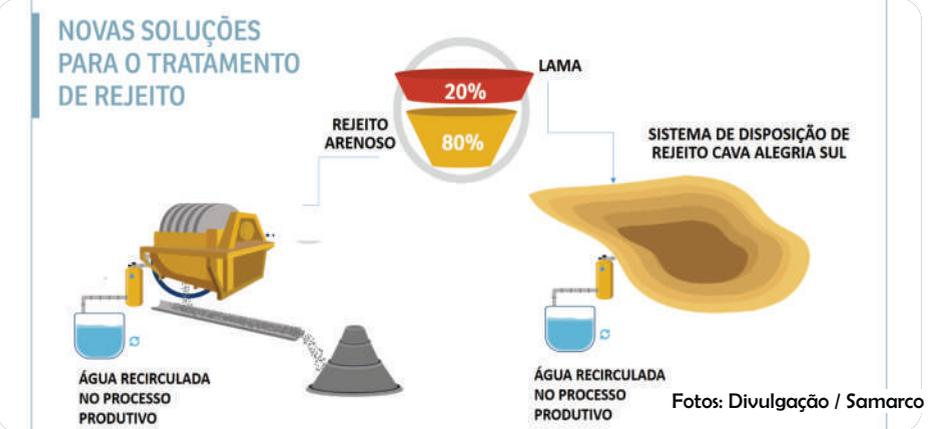
filtrada e empilhada a seco. O processo de filtragem permitirá o reaproveitamento de água.
