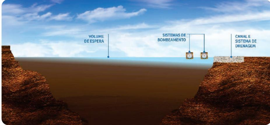
A Samarco retomará suas operações sem barragem de rejeitos e após a implantação total de um sistema de disposição e tratamento de rejeitos, que inclui a Cava Alegria Sul e a filtragem para o empilhamento a seco. Preparando-se para a retomada, a empresa finalizou, nessa terça-feira (28), a primeira etapa das obras na Cava Alegria Sul, localizada no Complexo de Germano, em Mariana, que receberá parte dos rejeitos gerados na lavra da mina.
